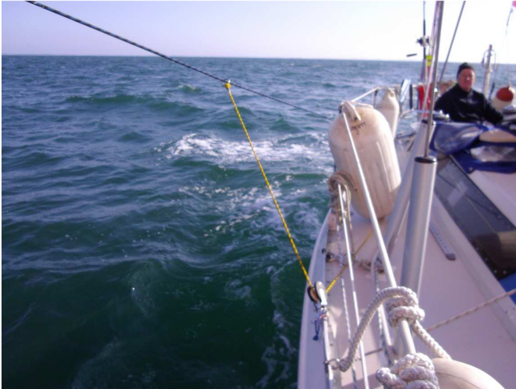
Le bras de spi passe dans l'anneau (ou poulie) de barber.
